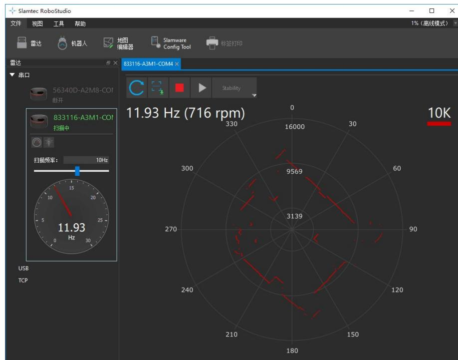
图表 2-10 Lidar 插件的电机调速对话框
