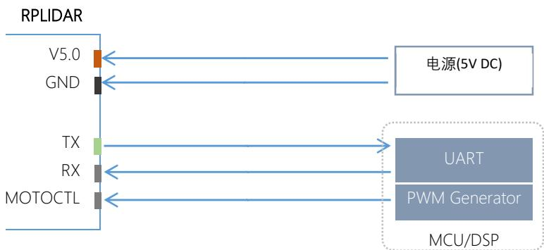
图表 3-3 RPLIDAR A2 模块引脚参考系统设计
