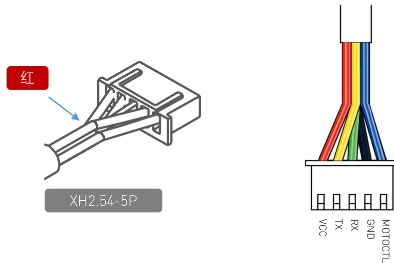
图表 3-1 RPLIDAR A2 模块引脚示意图
