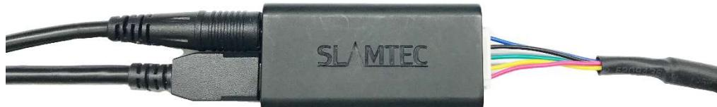
图表 2-2 连接 USB 转接器与 Micro-USB 实物图
