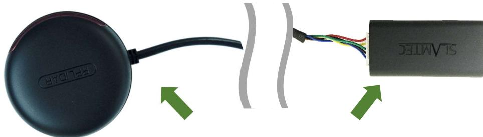
图表 2-1 连接 RPLIDAR A2 与 USB 转接器图
