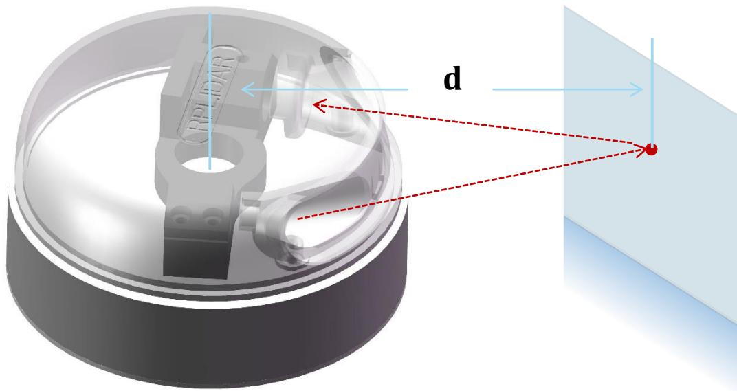
图表 1-2 RPLIDAR A3M1 工作原理示意图
