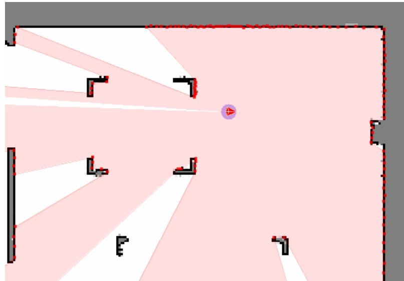
图 2.5.5 重定位成功后机器人位姿恢复
