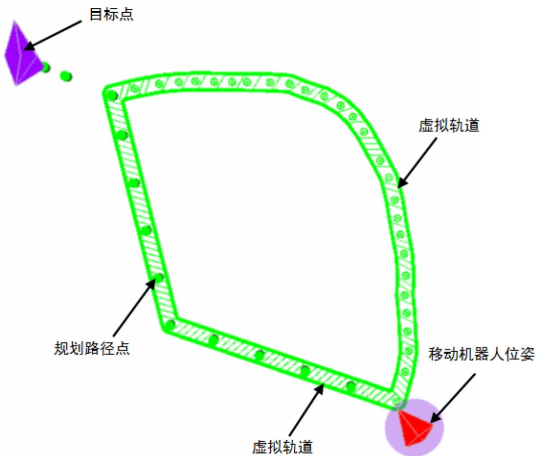
图 2.7.7 虚拟轨道巡航模式下的路径规划
