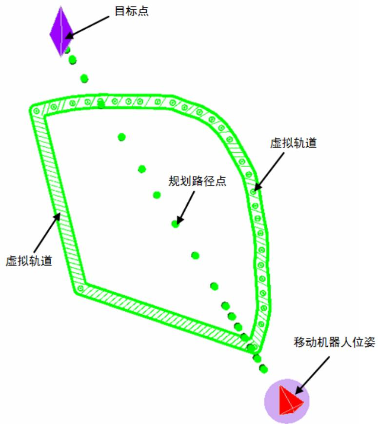
图 2.7.5 普通导航模式下的路径规划
