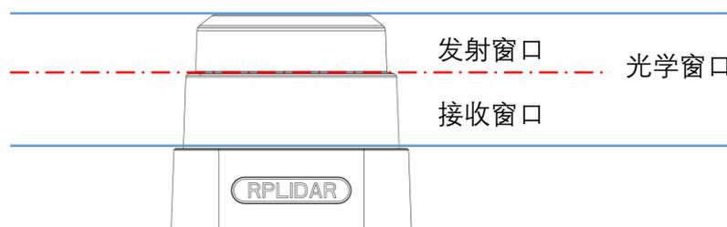
图表 2-3 RPLIDAR S1 光学窗口示意图
