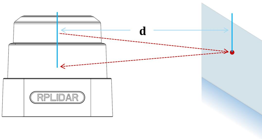
图表 1-2 RPLIDAR S1 工作原理示意图
