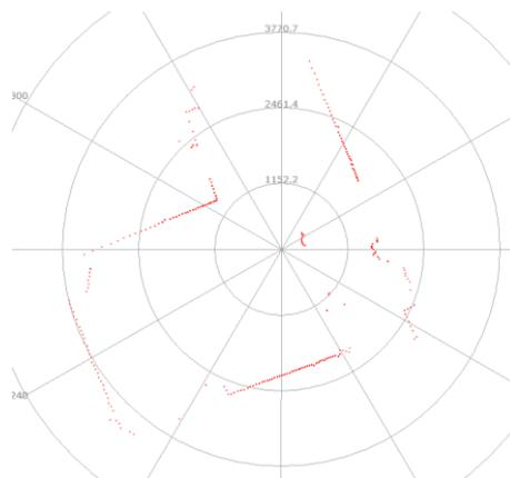
图表 1-3 RPLIDAR S1 扫描所得环境示意图
