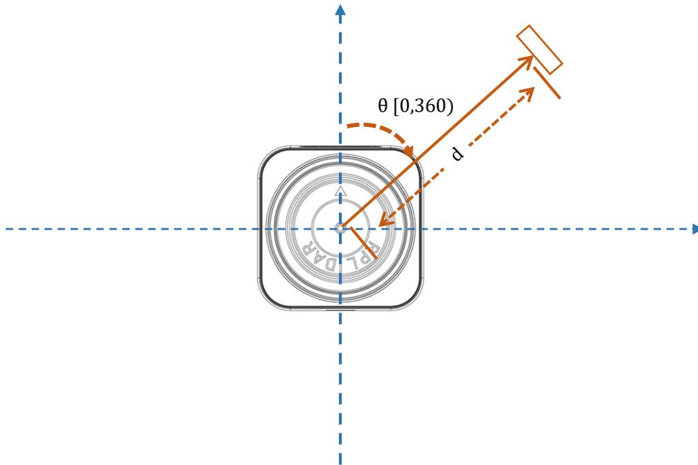
图表 2-4 RPLIDAR S1 扫描数据坐标系定义
