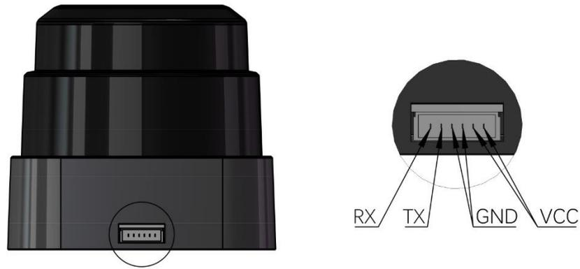
图表 2-5 RPLIDAR S1 母座接口定义示意图
