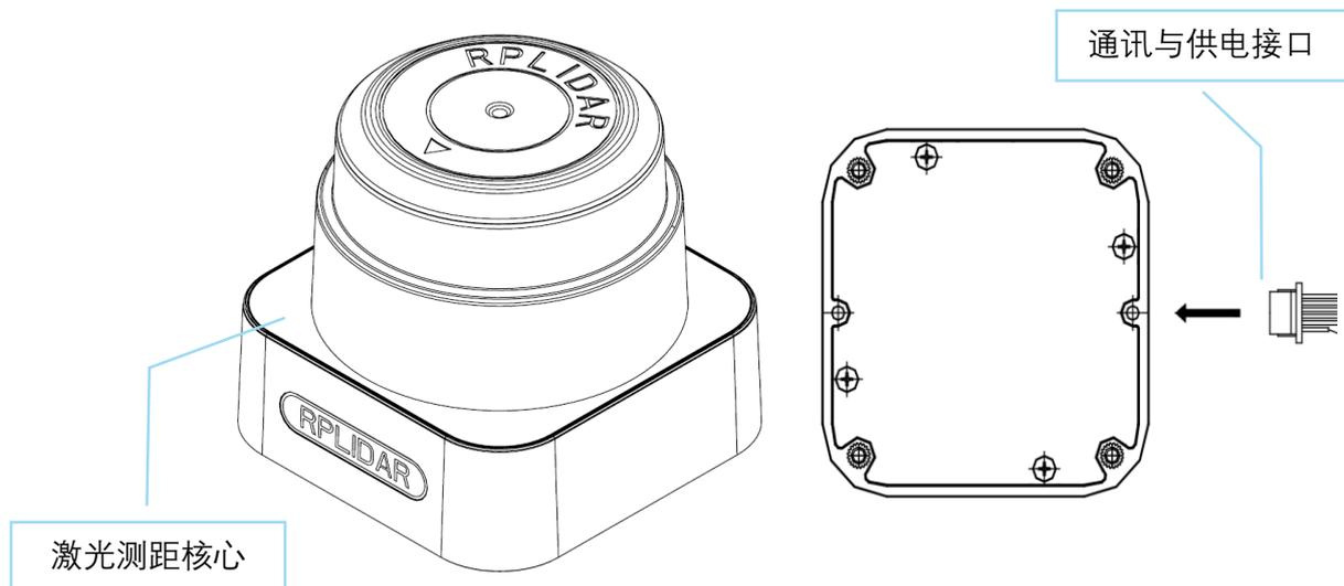
图表 1-1 RPLIDAR S1 系统构成示意图
