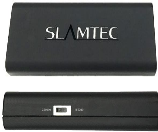
图表 1-3 RPLIDAR S1 USB 转接器实物图
