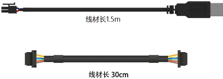
图表 2-6 SLAMTEC Mapper 配线示意图
